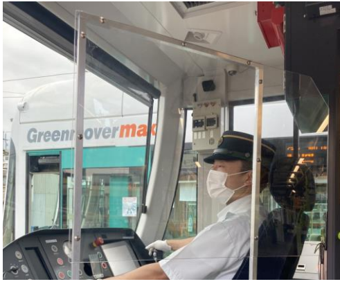
【飛沫感染防止スクリーン（アクリル板）の設置】
